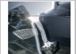
3.7 解码器线束：在原车方向盘中控台下方找到 OBD 接口。用我们的 OBD 与原车 OBD 对接再复原；
