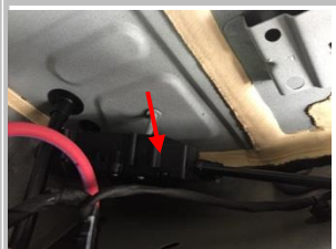
5.6 如图示意，把驱动盒用泡棉包住，把拉线露出外面；
