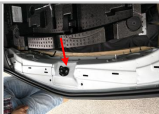
5.1 图示为已拆下后踏盖；
