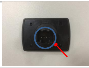
2.14 拆下内饰，根据中控开关，在内饰板上开一个 \phi 19\text{mm} 的孔
