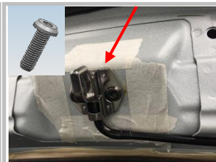
5.3 把我司锁扣组装上（用我司螺栓安装）根据箭头朝向正确安装，同时配合下门锁主体安装楔块安装，驱动盒放置左侧
