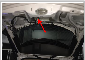
3.1 接门锁线：在尾门上方，箭头位置找到原车信号线插头；注意如图拍摄角度；
