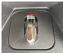
5.8 还原后踏盖，需要将上图红色区域用刀削一点。保证门锁与小盖布干涉。收拾工具，并检查运行是否顺畅
