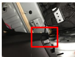
5.7 把包装好的驱动盒安装尾箱左侧如图空旷位置，需固定好，防止行车时松动；还原内饰时需根据所占空间切割泡沫棉至合适后放置好；
