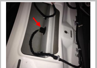
3.4 控制信号线的接线方法：在原车尾门上找到此处连接器；
